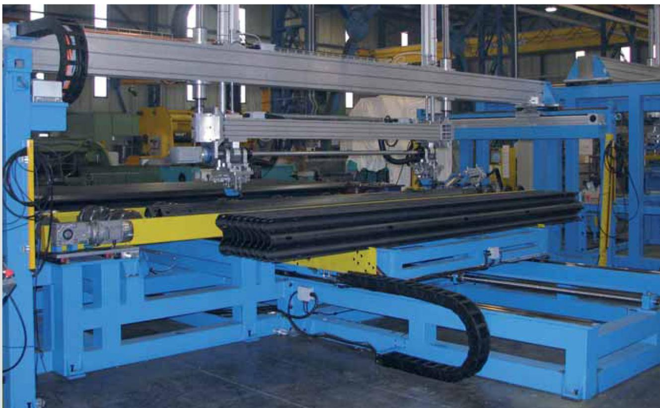
**Sistema di manipolazione per barriere di sicurezza stradale**, dispone verticalmente i guard rail in arrivo dalla linea di produzione.
